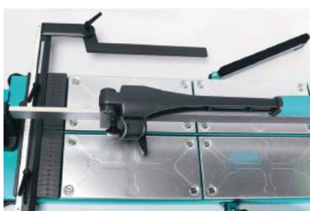
5. Podesive vodilice za rezanje pod kutom 0° i 45°
